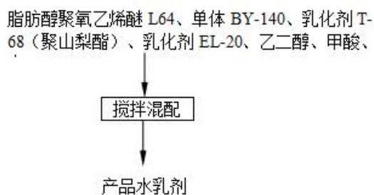
图 3.5-5 水乳剂生产工艺流程及产污节点图
