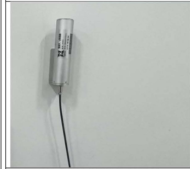
探伤室北墙监测报警装置探头
