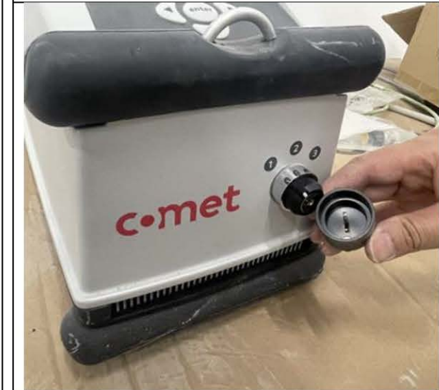
操作台处钥匙开关
