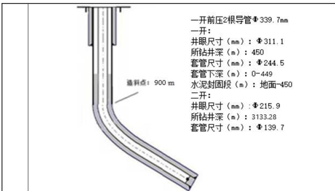
图 2-1 沙 102 井井身结构示意图
