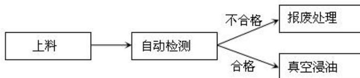
②由于企业新增 3 个客户，对产品质量要求较高，本次技改项目将新增客户需要的 880 万套粉末冶金零部件产品的生产工艺略有调整，现有项目工艺中油浸在本次技改项目工艺中更改为真空浸油，真空浸油流程见下图。
