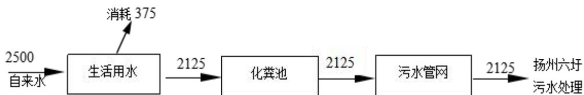
图 1-4 现有生产项目给水排水平衡图 (m<sup>3</sup>/a)
