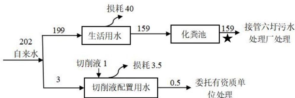
图 3-1 废水处理流程及监测点位图
