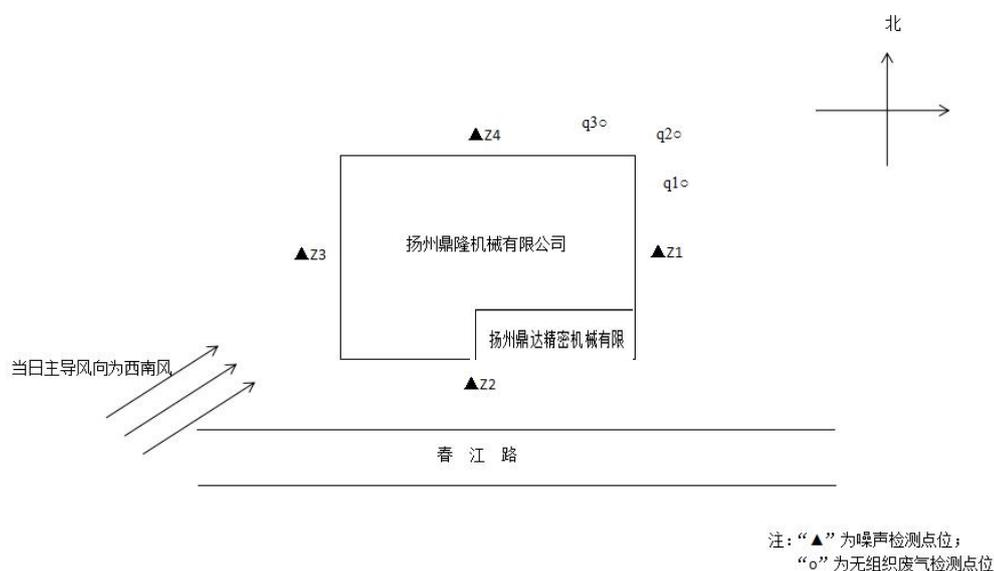
图 3-4 无组织废气、噪声监测点位图
