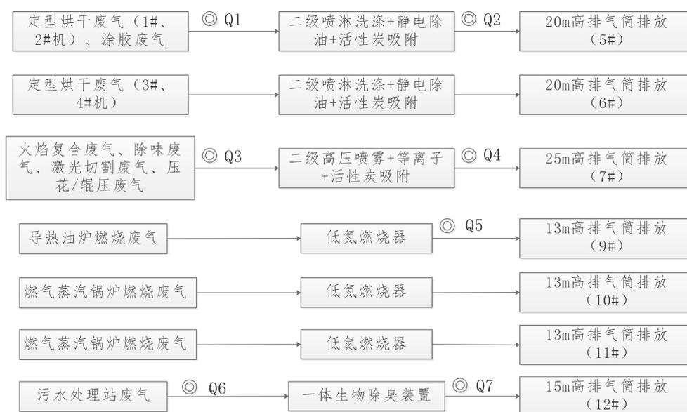
图 4-3 废气处理流程及监测点位图
